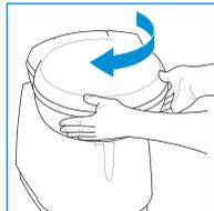
Sie können diese Schüssel in die gewünschte Stellung drehen (bis max.  $\pm 90^\circ$ ). Schließen Sie den Deckel und drehen Sie die Schüssel wie abgebildet mit beiden Händen.
