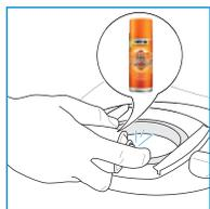
Er entfernt sicher hartnäckige Kalkablagerungen an der Innenseite des Tanks. Wenn die Dichtungen trocken werden, verwenden Sie das Thetford-Pflegemittel für
