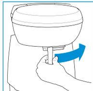
Die Toilette kann mit geöffnetem oder geschlossenem Schieber benutzt werden. Schieben Sie den Schiebergriff wie abgebildet zur Seite, um den Schieber zu öffnen. Achten Sie darauf,
