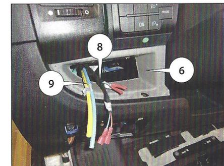
11. Luftleitungen (9) am elektrischen Bedienteil (7) anschließen.
