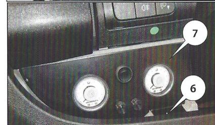
17. Kabelsatz (K) mit der elektrischen Leitung (C2 siehe Schaltplan S.52) für die Kompressorreinheit und Luftleitungen an die Kompressorreinheit verlegen.
