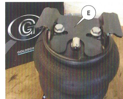
4. Legen Sie das Halteblech (F) zwischen Luftbalg und oberen Halter (G). Dieser wird mittels Senkkopfschraube M10 x 20 am Luftbalg befestigt. Bei der 8" Luftfeder wird der obere Halter jeweils mit 2 Senkkopfschrauben am Luftbalg befestigt. Bild rechts zeigt die richtige Vormontage des 8" Balgs mit Halter.
